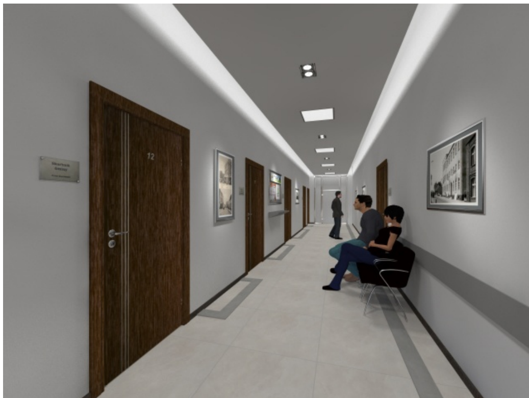
Światło ogólne i kierunkowe reflektory halogenowe oświetlające zdjęcia
